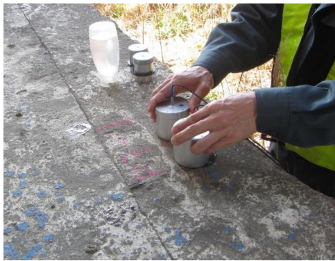
探触子設置状況
